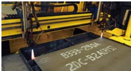
Strike Steel(鋼板の切り出し)の様子
