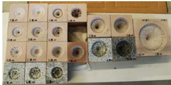
水中に設置した岩石試料に対するレーザ照射実験の結果 (写真提供: JOGMEC)
